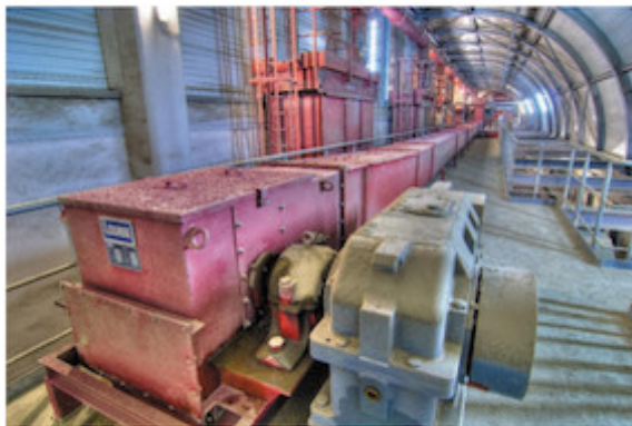
Foto1: Beispiel für einen AUMUND-Trogkettenförderer TKF Typ LOUISE (Foto AUMUND)
