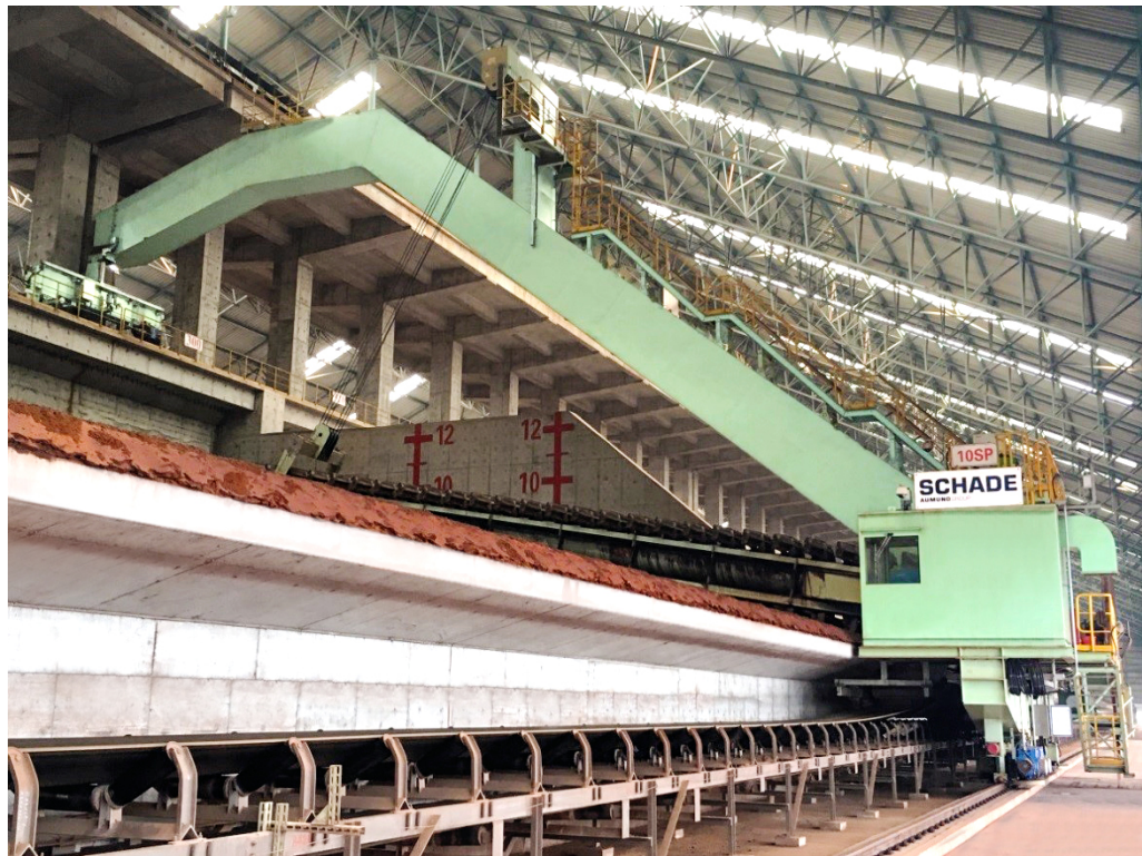
SCHADE-Halbportalkratzer für Baosteel im Betrieb (Foto SCHADE)
